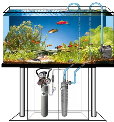
Montaggio sotto l'acquario con pompa separata dentro l'acquario
